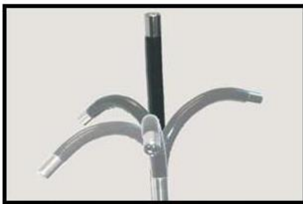
Slika 6.: Mogućnost daljinskog upravljanja vrhom fibroskopa
