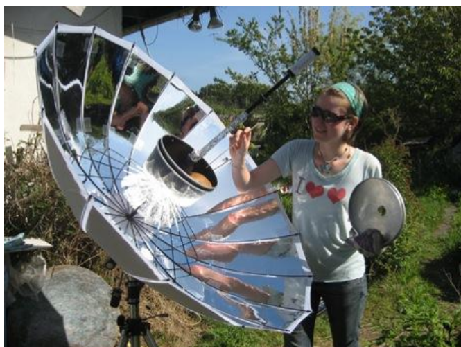
Sl.1.7. Tehnologija koncentrirajućeg solarnog zračenja u primjeni kuhanja[7]
