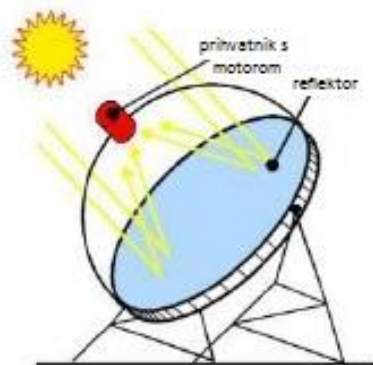
Sl.3.14.Koncept koncentriranja sunčevih zraka kod tanjurastog paraboličnog kolektora [22]
