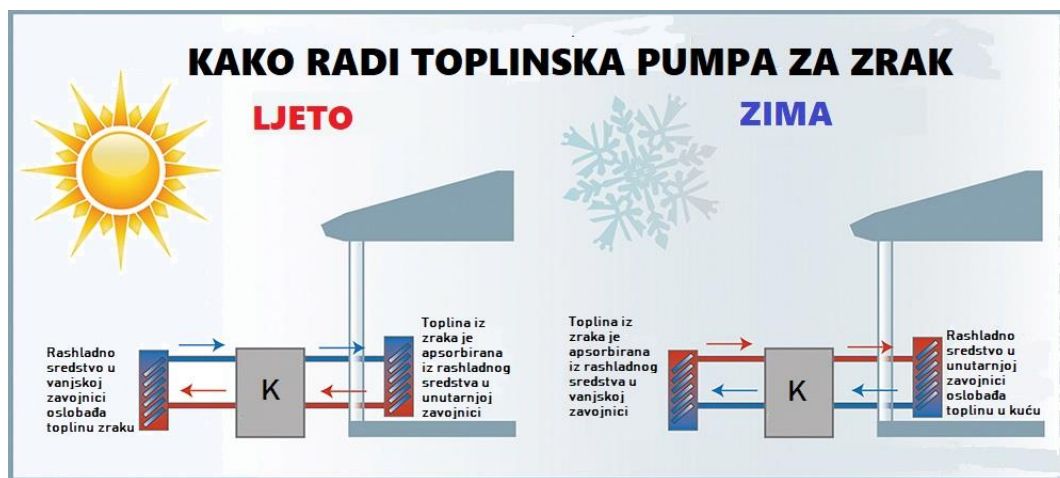
Slika 4. Princip rada toplinske pumpe za zrak
