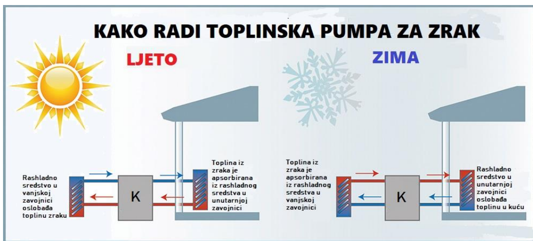
Slika 4. Princip rada toplinske pumpe za zrak
