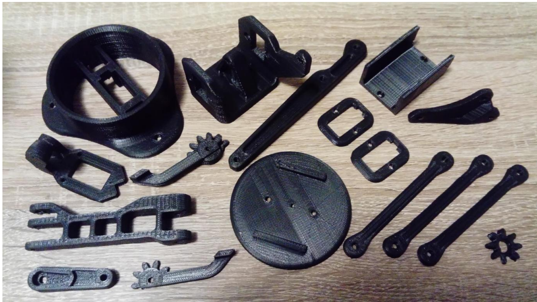
Slika 6.3 – Ispisani dijelovi modela robotske ruke
