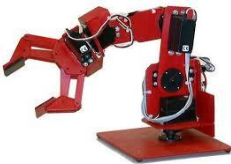
Slika 3.1 – Mehanička struktura robotske ruke s aktuatorima
