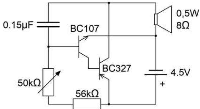
Princip rada : Pomoću dva tranzistora u spoju pokušavamo ostvariti oscilator koji će generiti signal određene frekvencije. Frekvenciju određujemo preko radnih točaka tranzistora, koje dobivamo iznosima otpornika i kondenzatora koje imamo u krugu. Potenciometrom mijenjamo napon na bazi tranzistora BC107 te struje što dovodi do promjene frekvencije koju oscilator generira. Kao rezultat cijelog procesa dobivamo zvuk na zvučniku.
