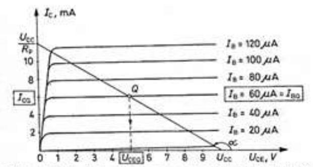
Slika 3.5 Proizvoljni radni pravac provučen kroz radnu točku
