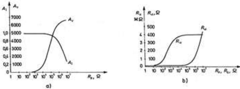
Slika 2.9 Ovisnost ulaznog otpora o Slika 2.10 Ovisnost Izlaznog otpora o
