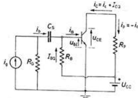
Slika 3.7 Dovođenje strujnog signala na ulaz pojačala
