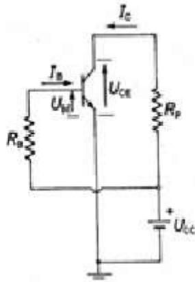
Slika 3.6 Realiziranje istosmjernog strujnog generatora u krugu baze
