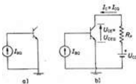
Slika 3.4 Podešavanje statičke radnje točke bipolarnog tranzistora :
