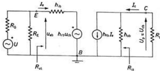
Slika 2.8 Nadomjesni sklop pojačala za mali izmjenični signal
