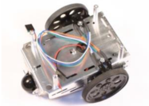
Slika 3.5 Prikaz nakon montaže servo motora, kotača i kuglastog kotača
