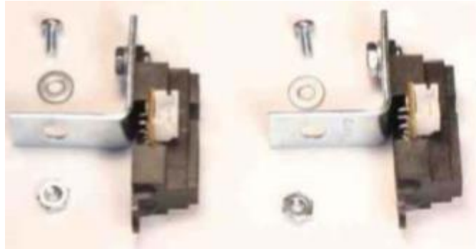
Slika 3.6 a) Postavljanje L nosača na senzore udaljenosti
