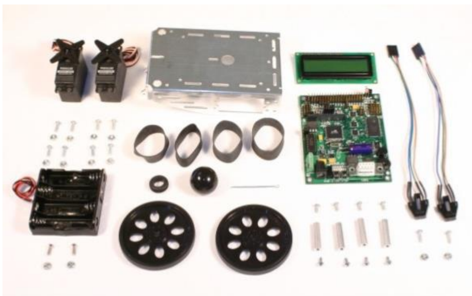
Slika 3.1 Dijelovi mobilnog robota u kit-kompletu
