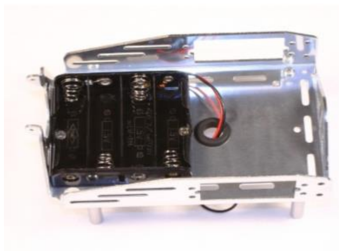
Slika 3.3 Prikaz montaže držača baterije postavljene na donjoj strani kućišta robota
