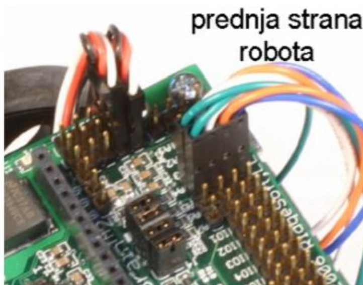
Slika 3.11 Spajanje senzora za kretanje kotača na upravljački kontroler
