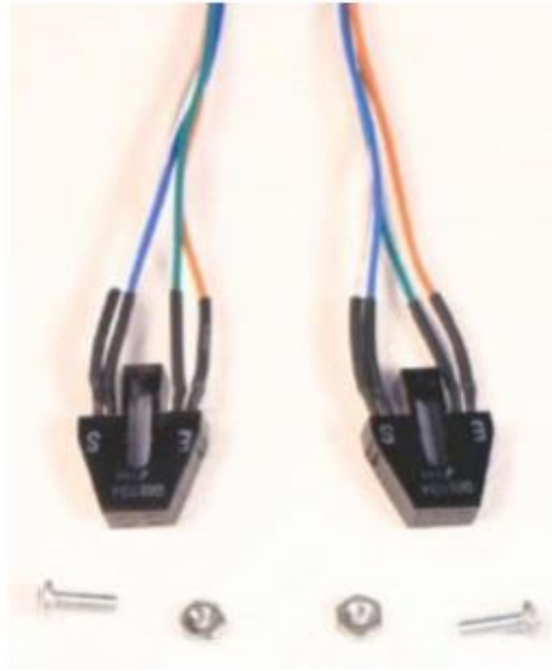
Slika 3.24 Infracrveni fotoreflektivni senzori i njihovi elementi za spajanje na kućište robota
