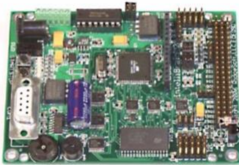
Slika 3.30 Prikaz upravljačkog kontrolera sa raznim priključnim iglama
