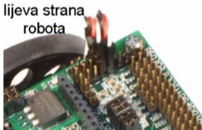
Slika 3.9 Povezivanje servo motora na upravljački kontroler
