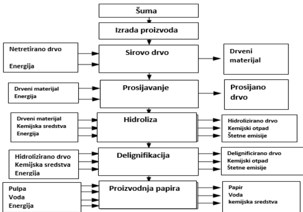
Slika 8. Shematski prikaz izrade korištenjem drvenog otpada [15].
