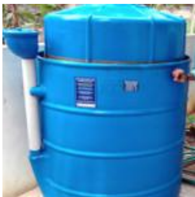
Slika 7. Digester kapaciteta 1 m 3 [7].
