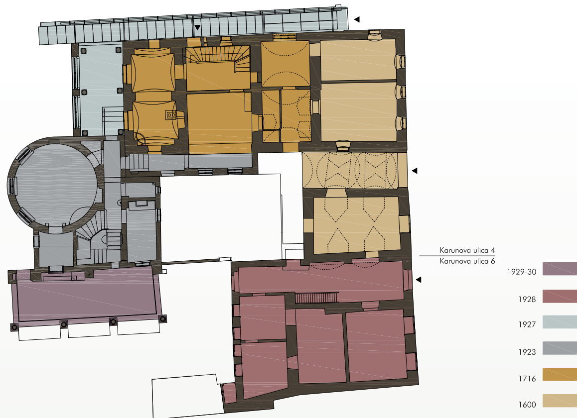
Plečnikova kuća, kronologija gradnje
