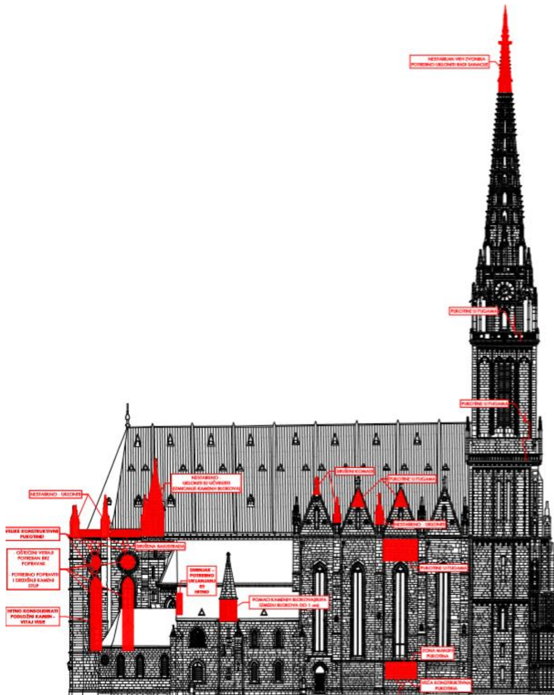
Slika 17: Prikaz oštećenja katedrale sa sjeverne strane
