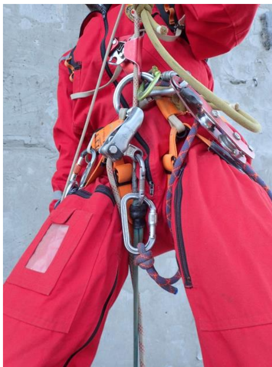
Slika 11: Prelazak shunta metodom prelaska uzla
