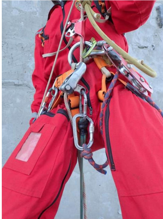
Slika 11: Prelazak shunta metodom prelaska uzla
