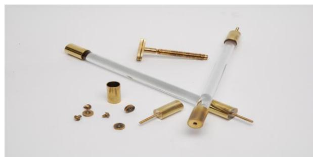
Slika 2.3 Dijelovi voltinog niza
