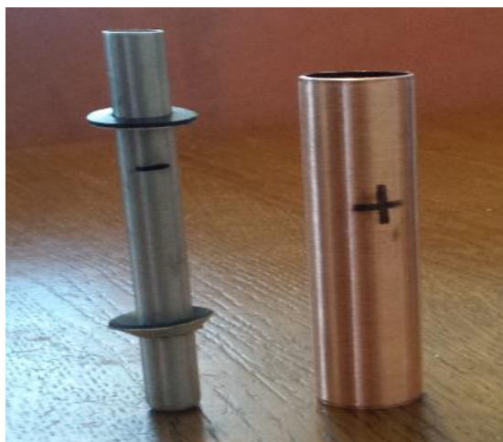
Slika 5.1.2 Stavljanje brtvi na aluminijsku cijev
