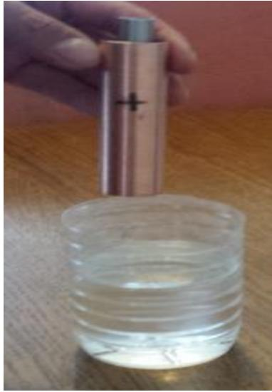
Slika 5.1.7 Stavljanje anode i katode u elektrolit
