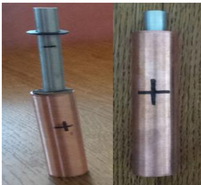
Slika 5.1.3 stavljanje aluminijske cijevi u bakrenu
