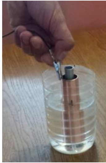
Slika 5.1.8 Spajanje sa hvataljkama
