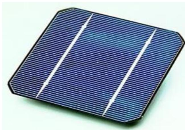
Slika 3.13 Solarna čelija
