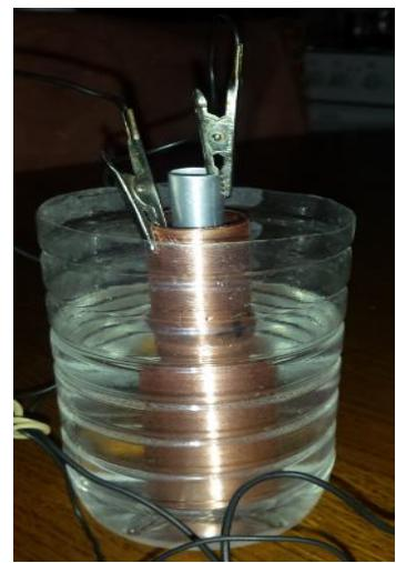
Slika 5.1.9 Spojene anoda i katoda s hvataljkama
