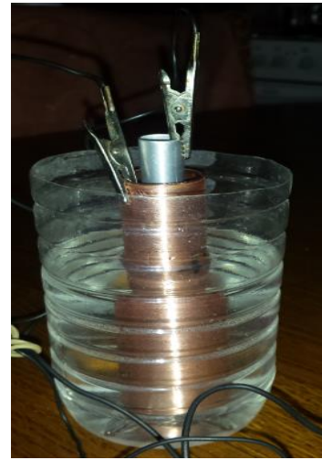
Slika 5.1.9 Spojene anoda i katoda s hvataljkama
