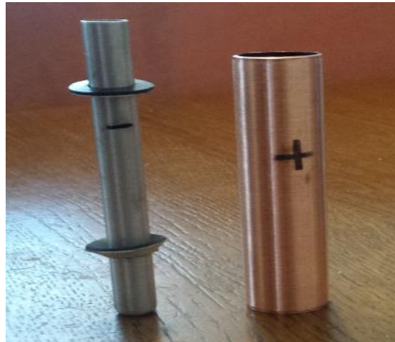
Slika 5.1.2 Stavljanje brtvi na aluminijsku cijev
