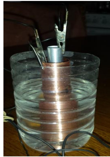
Slika 5.1.9 Spojene anoda i katoda s hvataljkama
