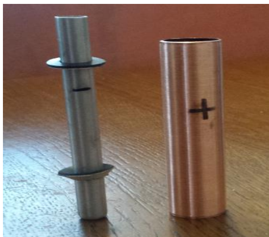
Slika 5.1.2 Stavljanje brtvi na aluminijsku cijev
