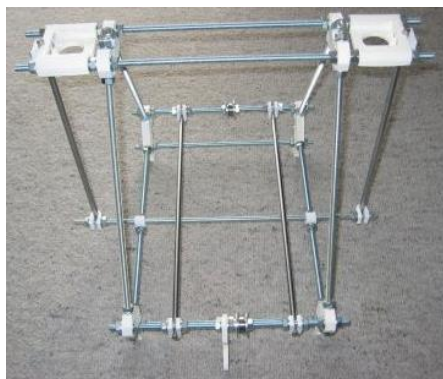
Slika 3.6. Okvir 3D printera.
