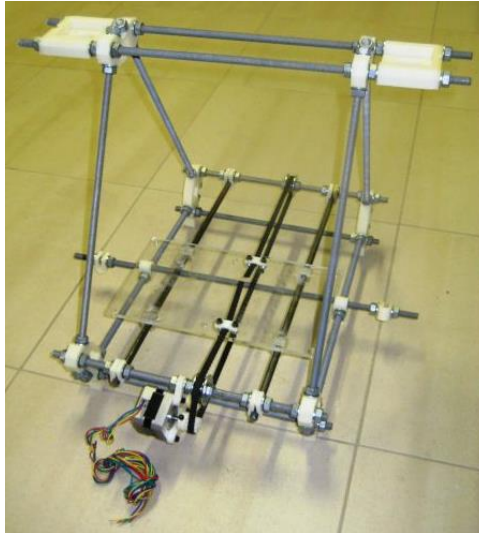
Slika 3.7. Okvir 3D printera sa platformom na Y-osi.
