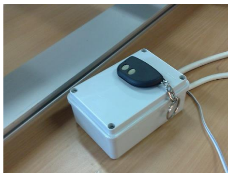
Slika 4.3. Sustav za daljinsko upravljanje
