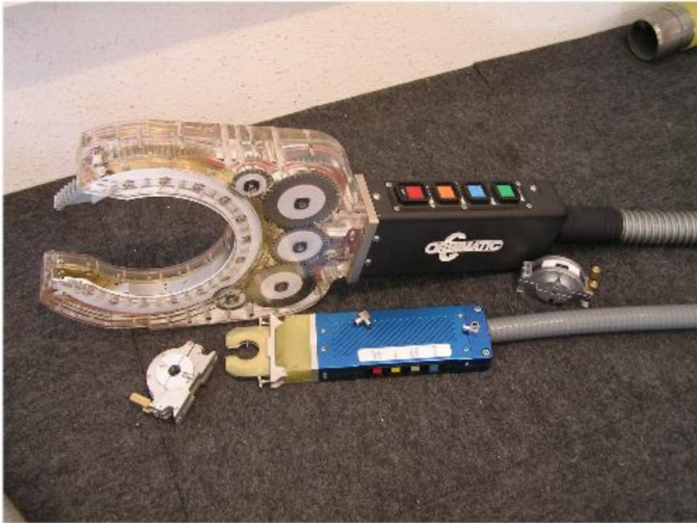
Slika 3.7 Primjer zatvorenih glava za orbitalno TIG zavarivanje
