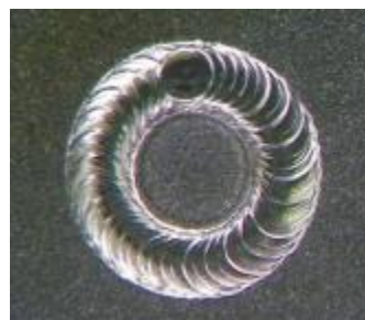
Slika 5.3. Izgled zavarenog spoja izvedenog laserom [3]
