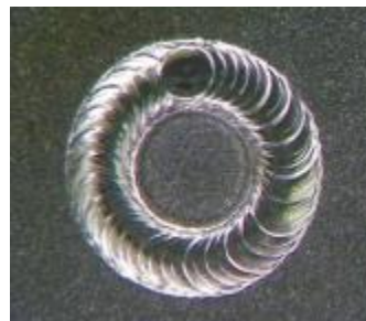
Slika 5.3. Izgled zavarenog spoja izvedenog laserom [3]
