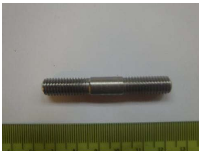
Slika 3.9. Implant uzorak s obostranim navojem
