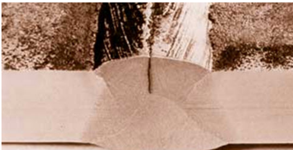
Slika 4.3. Uzdužna topla pukotina u zavaru
