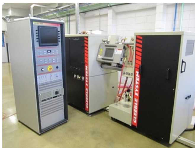
Slika 2.9. Simulator toplinskog ciklusa Gleeble
