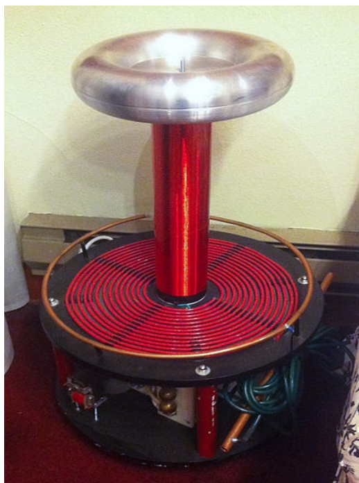
Slika 4.1 Moderno izveden Teslin transformator
