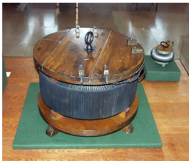
Slika 2.3 Suhi transformator ZBD tima
