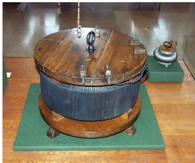
Slika 2.3 Suhi transformator ZBD tima
