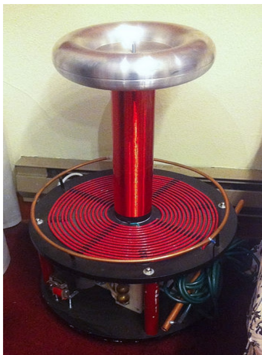
Slika 4.1 Moderno izveden Teslin transformator
