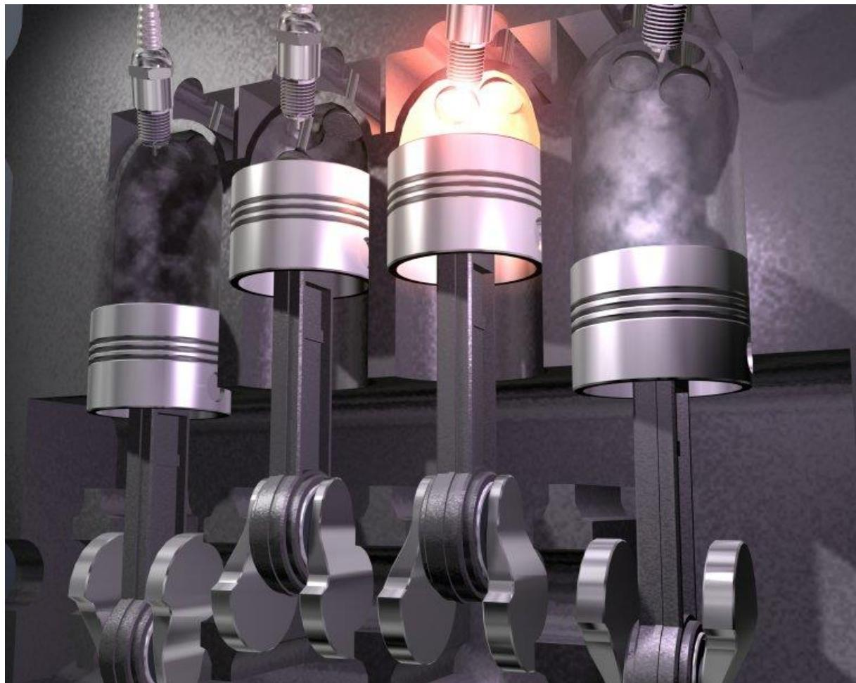
Slika 5.3 3D animacija četverotaktnog motora.
