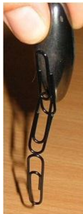
Slika 2.3. Lančani utjecaj magnetizma na spajalice.
