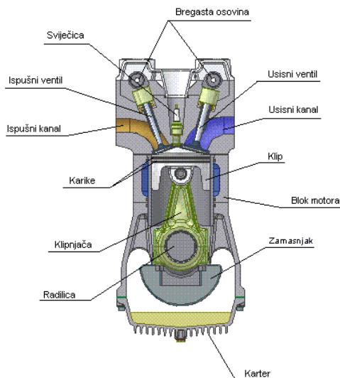
Slika 1. Četverotaktni otto motor, [20]
