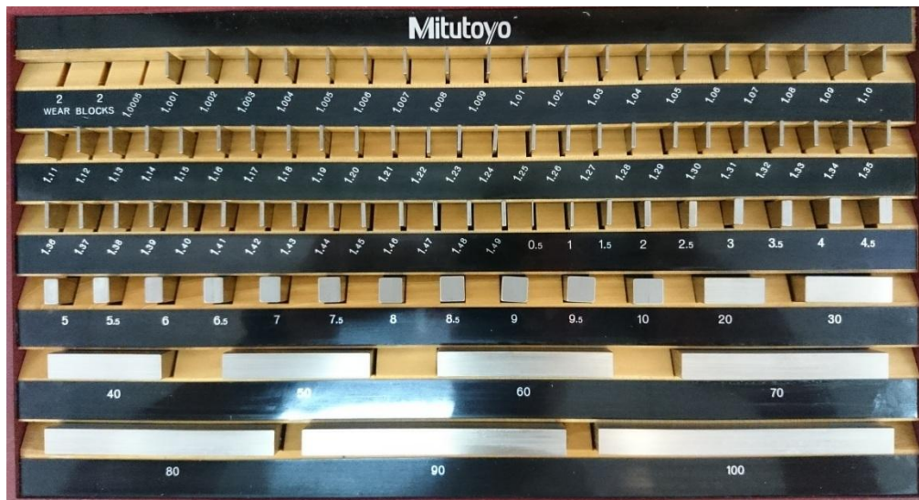
Slika 3.23. Mjerne pločice „etaloni“
