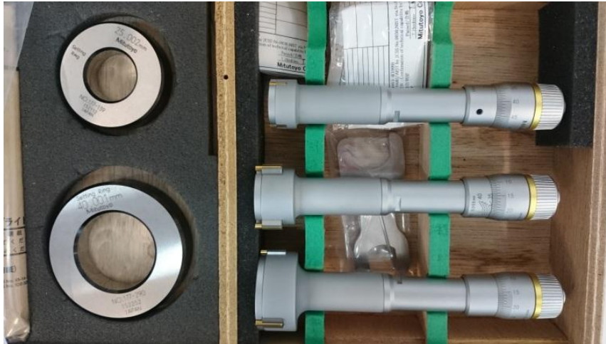
Slika 3.24. Mikrometar za provrte s kontrolnim prstenovima
