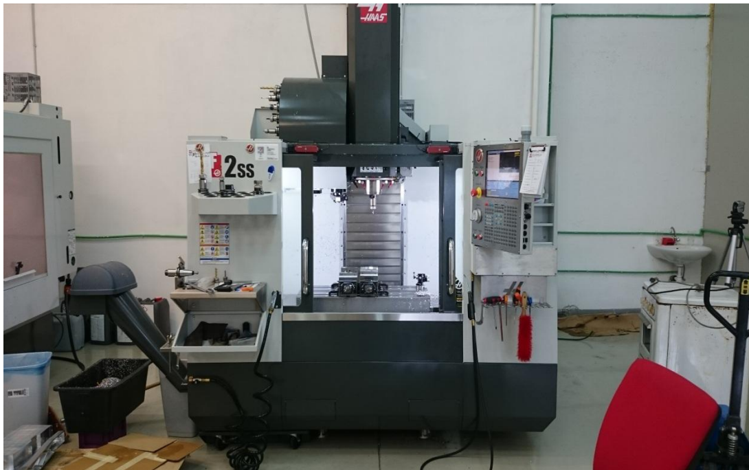
Slika 3.1. CNC obradni centar „Haas VF-2SS“
