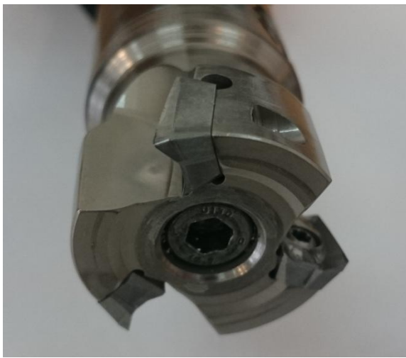
Slika 3.11. Glodalo s pločicama za obradu aluminija
