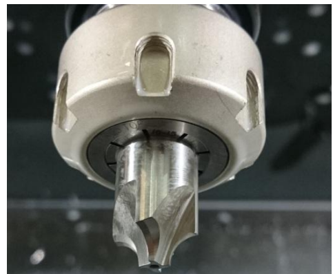
Slika 3.14. Glodalo za izradu zaobljenih rubova
