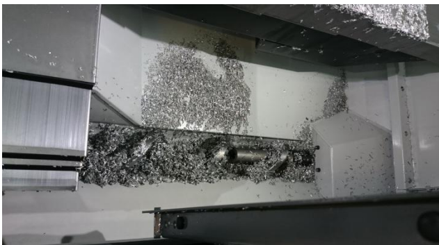
Slika 3.3. Pogon za odstranjivanje strugotine
