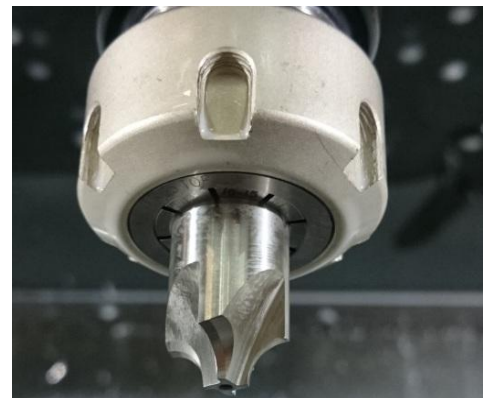
Slika 3.14. Glodalo za izradu zaobljenih rubova
