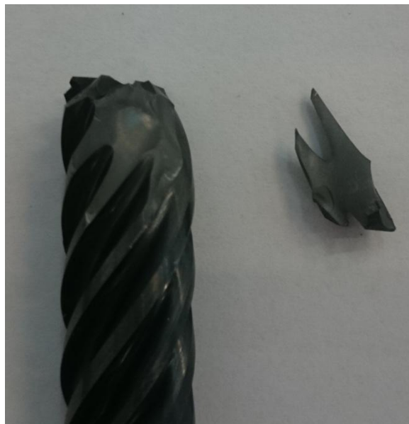
Slika 3.16. Oštećeno TPC glodalo
