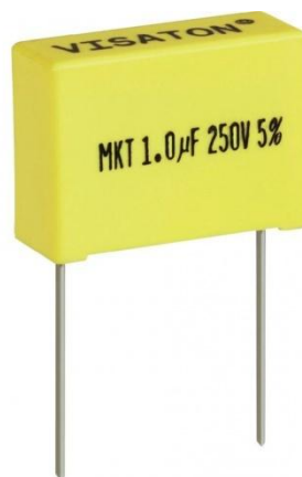
Slika 6.2. Folijski kondenzator
