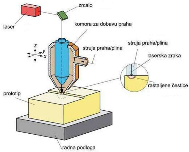
Slika 4.12.Princip LENS postupka
