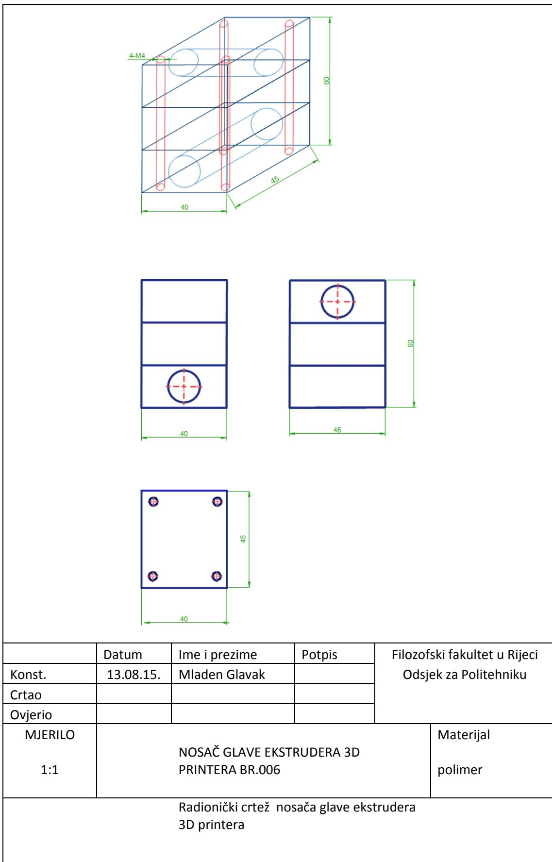
Slika 6.8. Nosač glave ekstrudera 3D printera
