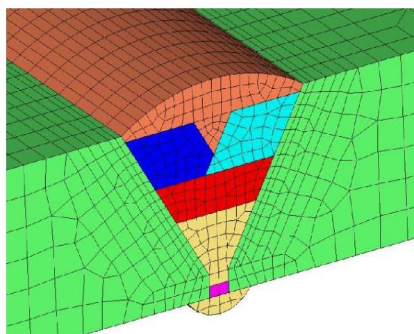
Slika 2.3.Trodimenijski model zavarenog spoja
