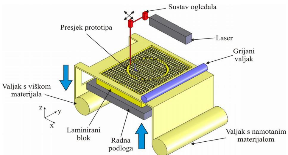
Slika 4.11. Shematski prikaz rada LOM uređaja
