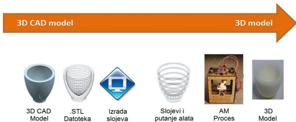
Slika 4.2. Faze brze izrade prototipova
