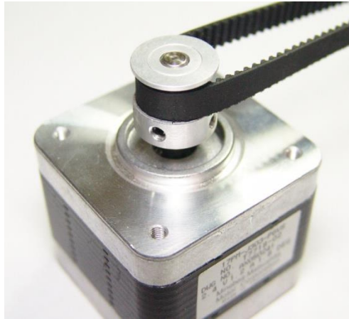
Slika 6.6. Motor NEMA 17 s remenicom i remenom
