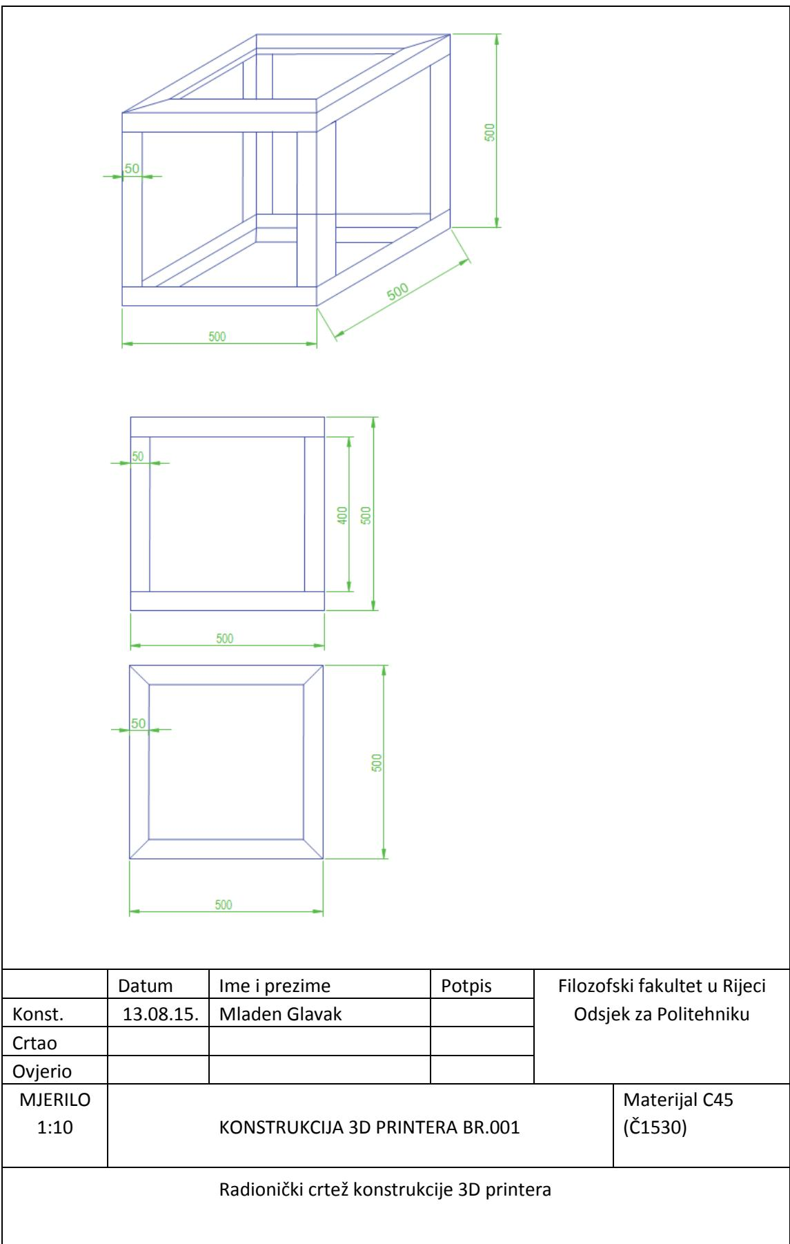
Slika 6.1. Konstrukcija 3D printer-a
