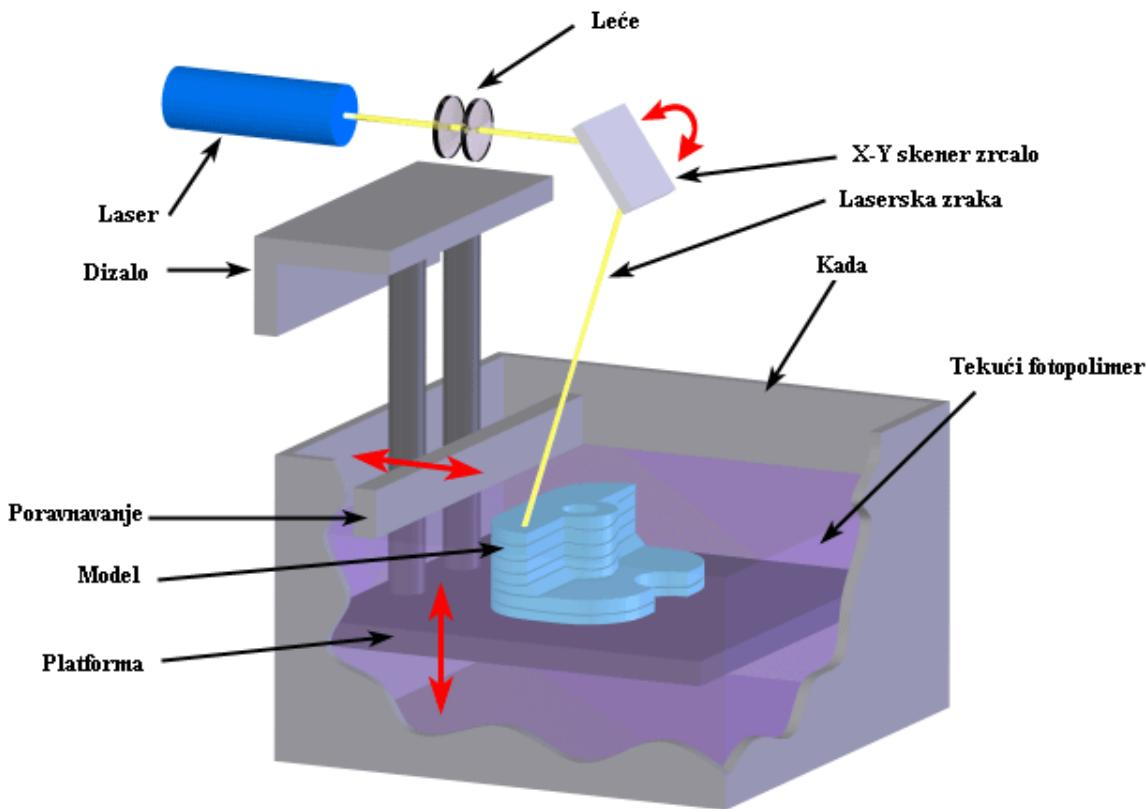
Slika 1. Slika 4.3.Princip rada SL postupka
