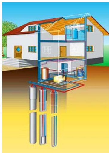
Slika 9: Izvedba sa dubinskom sondom [9]
