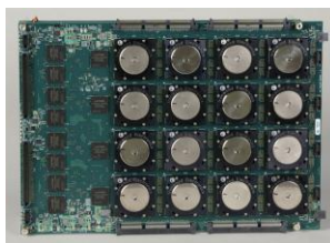
Slika 6.1. IBM-ova ploča sa 16 neuromorfih čipova
