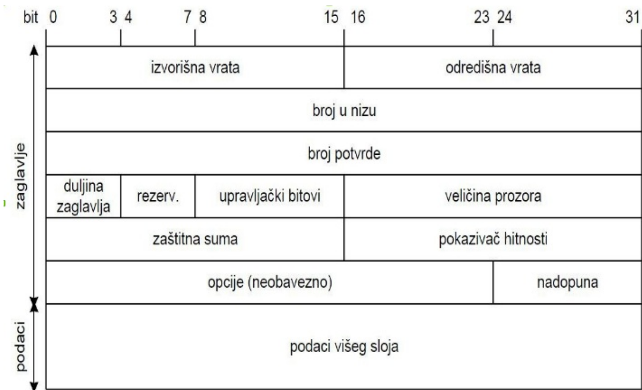
Slika 1: Struktura TCP segmenta
