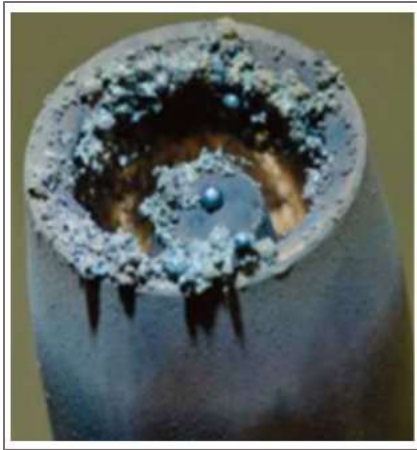
Slika 2.33. Čahura začepljena zbog prskanja kapljica [9]
