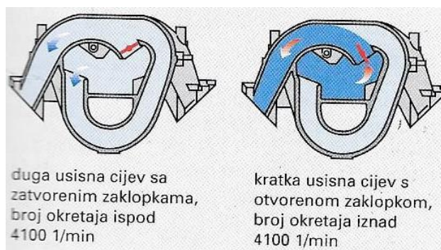
Slika 2.2. Oscilacijska usisna grana [2]
