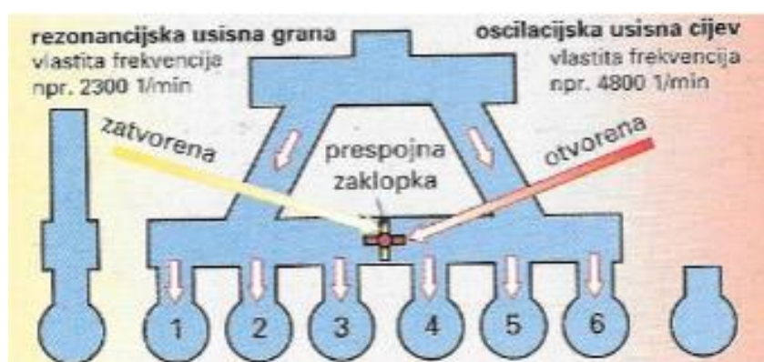
Slika 4.46. Dinamičko prednabijanje motora
