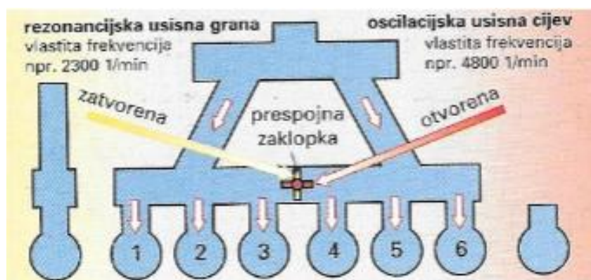
Slika 4.46. Dinamičko prednabijanje motora
