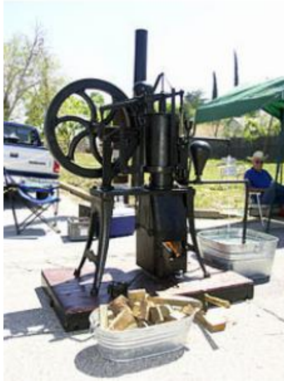
Slika 4. Crpka za vodu pokretana Stirlingovim motorom [38]
