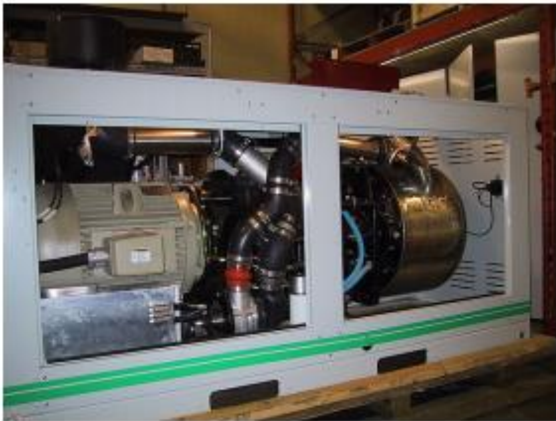
Slika 27. Stirling motor od 55 kW [42]
