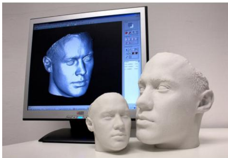
Slika 3.24. Proces od sistemskog softverskog modela do izratka [38]
