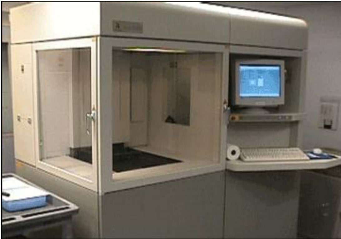
Slika 3.15. Uređaj za stereolitografiju SLA- 5000
