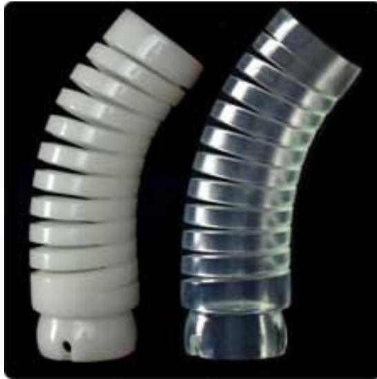
Slika 3.20. Primjer proizvoda napravljen selektivnim laserskim srašćivanjem [31]
