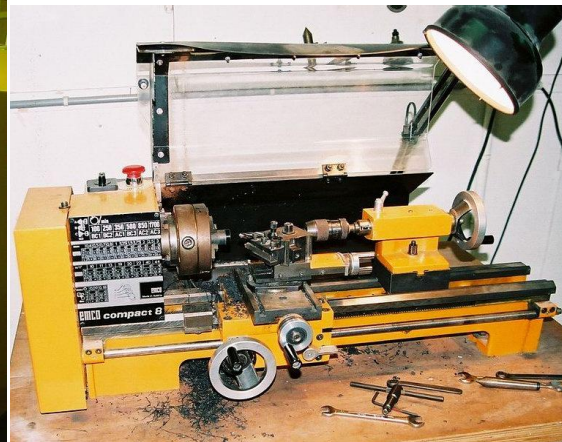
Slika 3.6. Univerzalni tokarski stroj
