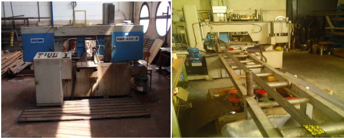
Slika 5.1. Tračna pila VETOR HAP-400
