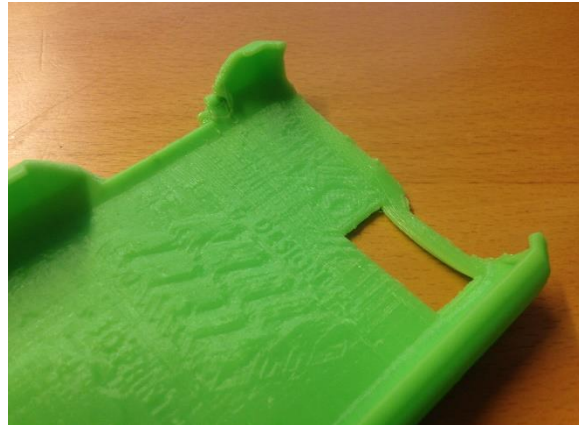
Slika 4.3. Greška prilikom printanja (2) [17]
