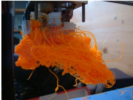
Slika 4.2. Greška prilikom printanja (1) [17]
