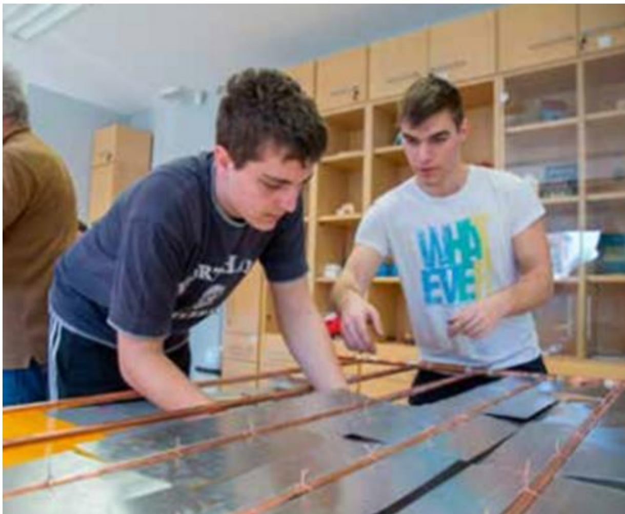
Slika 3.10. Povezivanje aluminijskih krilaca bakrenom žicom
