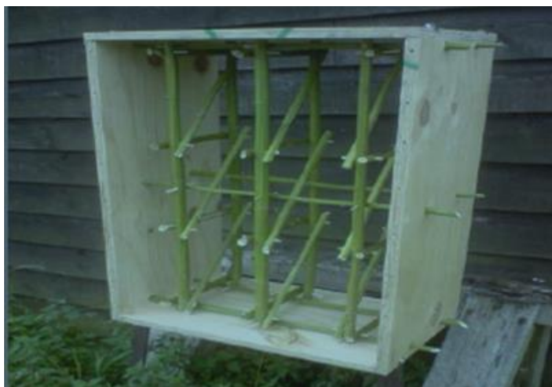
Slika 4.4. Armirani kalup za konopljin blok [12]
