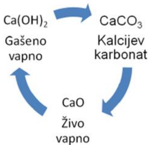
Slika 4.2. Cirkularni tok vapna
