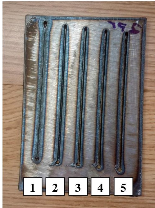
Slika 6.6. Uzorak plazma rezanja uz promjenu struje debljine 2 mm
