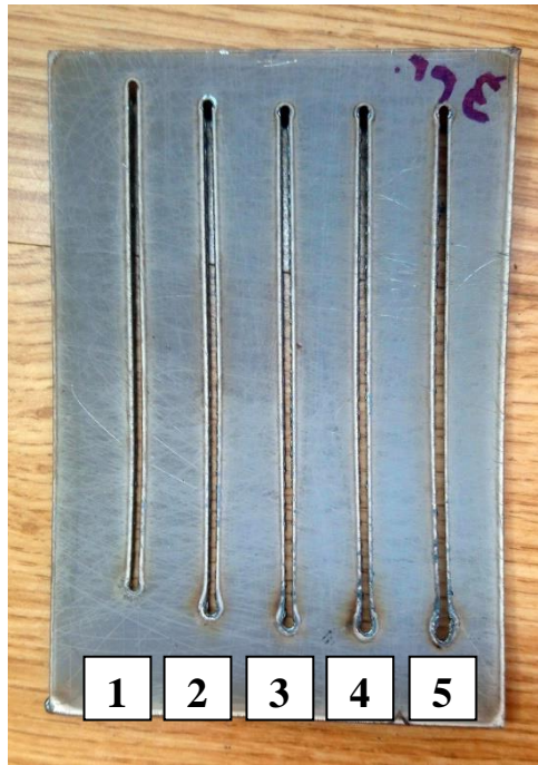
Slika 6.8. Uzorak plazma rezanja uz promjenu struje debljine 1 mm
