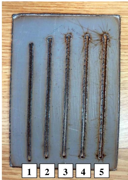
Slika 6.9. Poleđina uzoraka odrezanih plazma rezanjem debljine 1 mm
