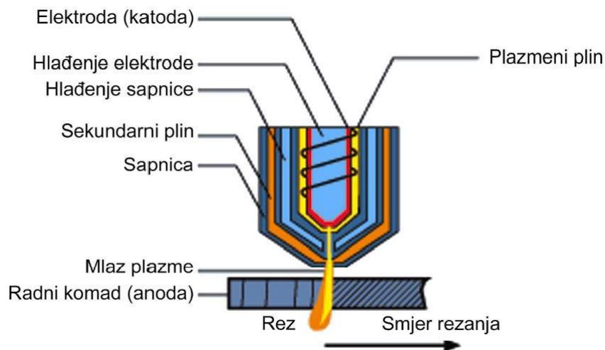
Slika 4.2. Rezanje plazmom sa sekundarnim medijem (rotirajući plin) [7]
