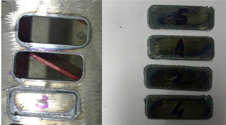
Slika 6.2. Uzorci nakon plazme rezanja
