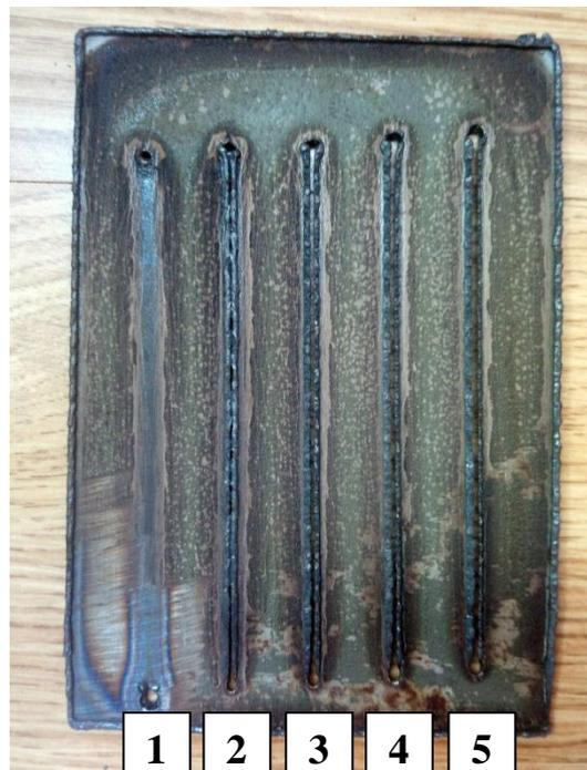
Slika 6.7. Poledina uzoraka odrezanih plazma rezanjem debljine 2 mm
