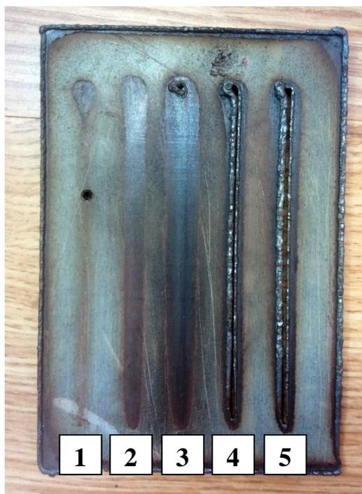
Slika 6.5. Poledina uzoraka odrezanih plazma rezanjem debljine 3 mm
