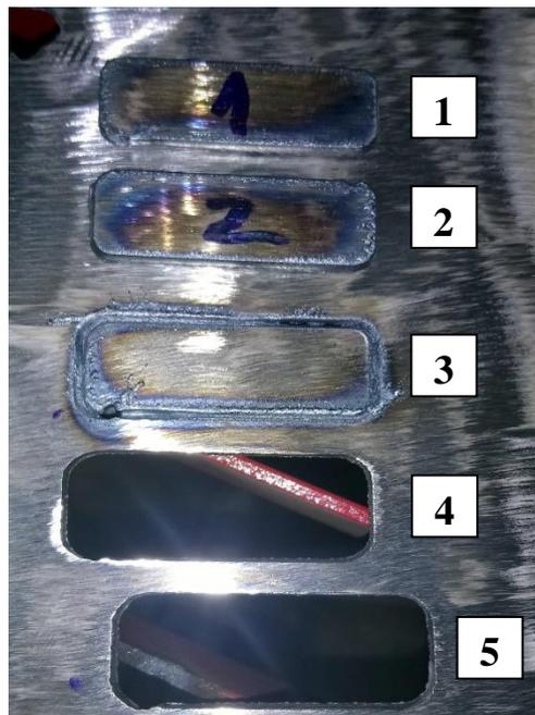
Slika 6.1. Primjer uzoraka uz 3 promjene brzine
