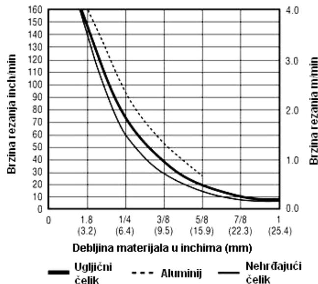
Slika 5.1. Brzina rezanja u ovisnosti o debljini materijala [4]
