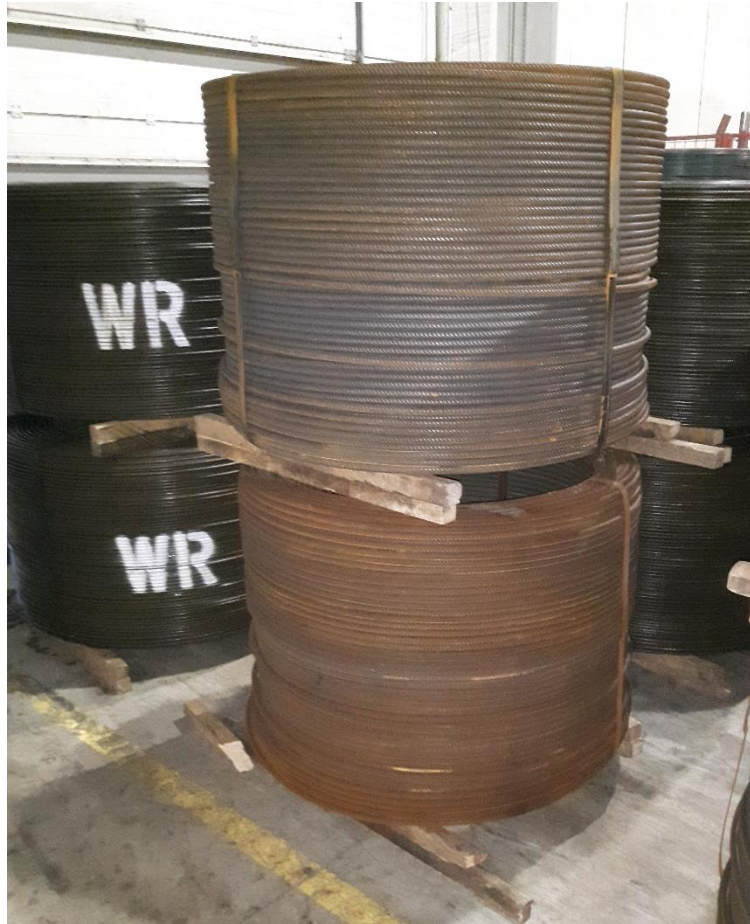
Slika 4.4. Pakiranje betonskog rebrastog željeza
