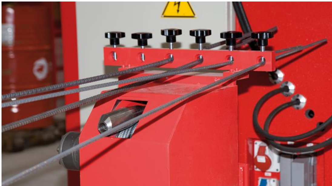
Slika 4.8. Vitlo za povlačenje žice [12]
