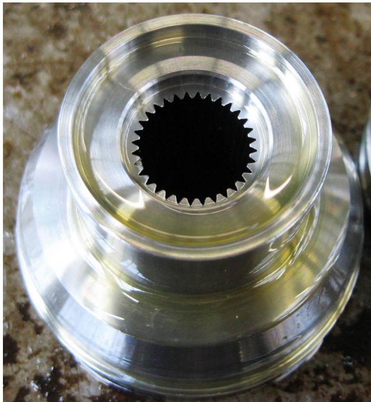
Slika 1.6. Primjer provrta napravljenog provlačenjem (žlijebni spoj) [4]
