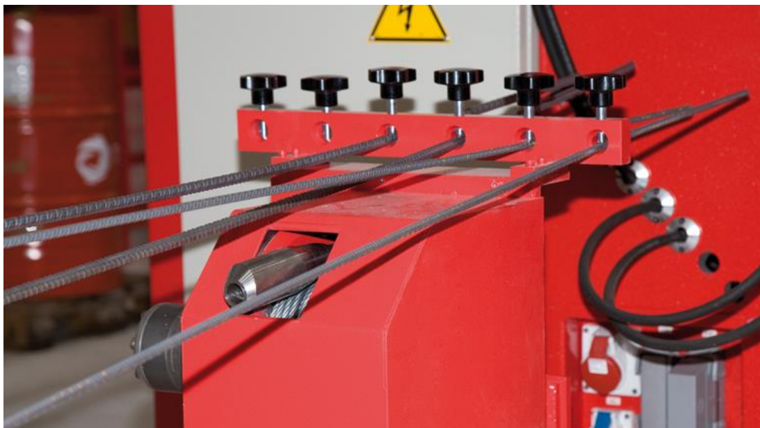
Slika 4.8. Vitlo za povlačenje žice [12]
