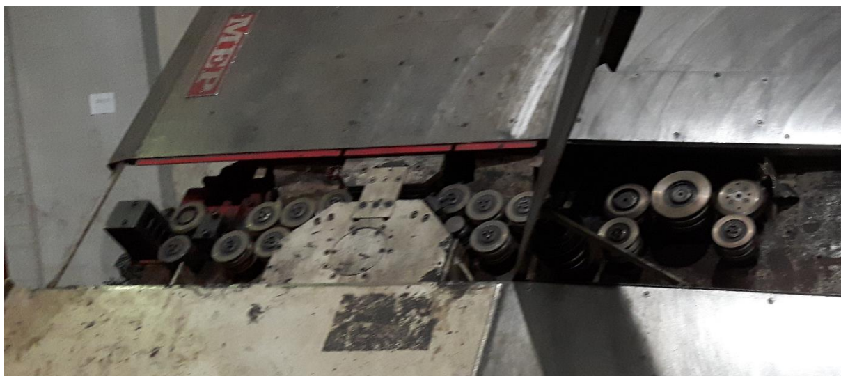
Slika 4.2. Kombinacija patentiranih valjaka
