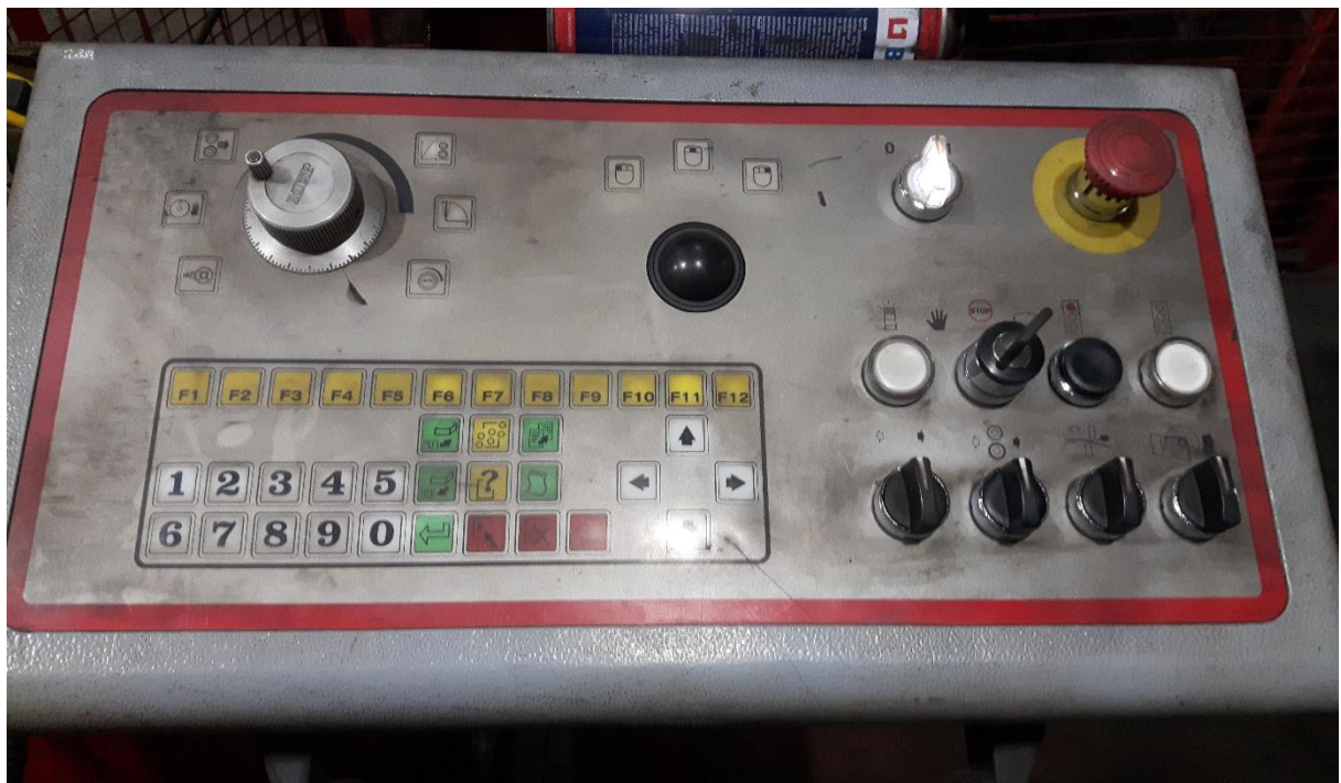
Slika 4.15. Kontrola svih parametara putem potenciometra
