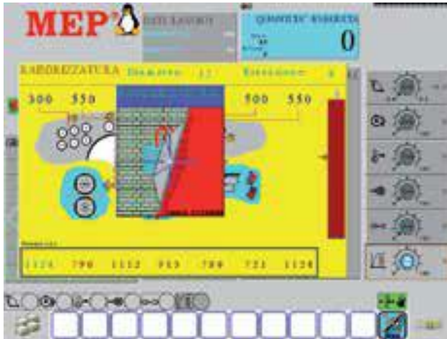
Slika 4.5. Korekcija žice tijekom radnog ciklusa [12]
