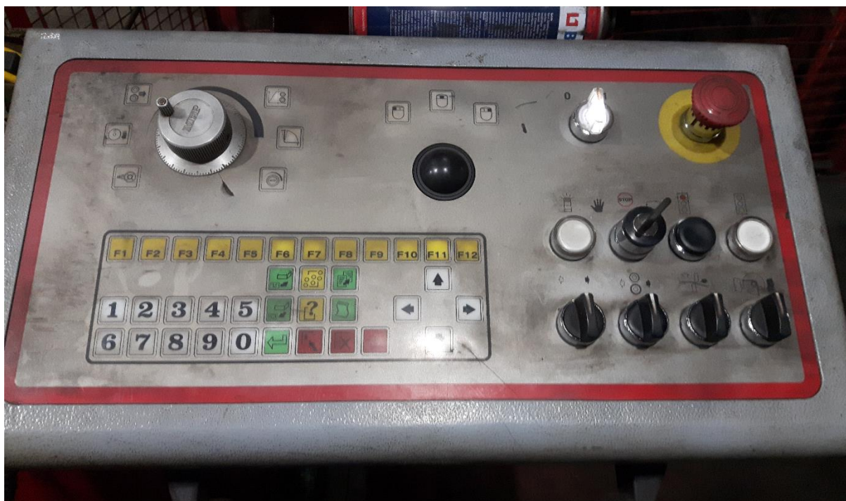
Slika 4.15. Kontrola svih parametara putem potenciometra
