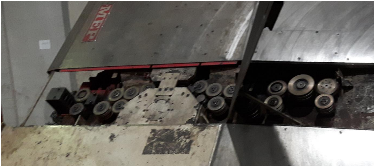
Slika 4.2. Kombinacija patentiranih valjaka
