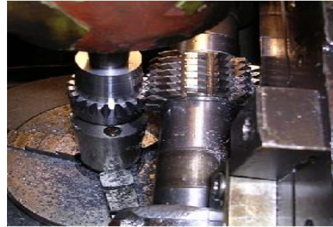
Slika 1.29. Odvalno glodanje zupčanika
