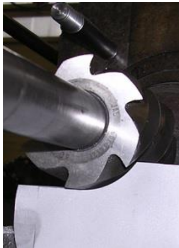
Slika 1.25. Obodno istosmjerno glodanje
