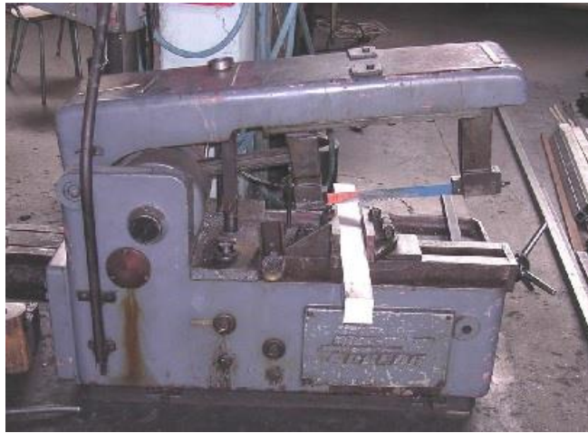
Slika 1.42. Prikaz okvirnog piljenja
