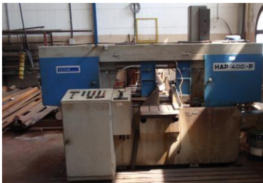
Slika 5.1. Prikaz tračne pile Vetor HAP 400 – P
