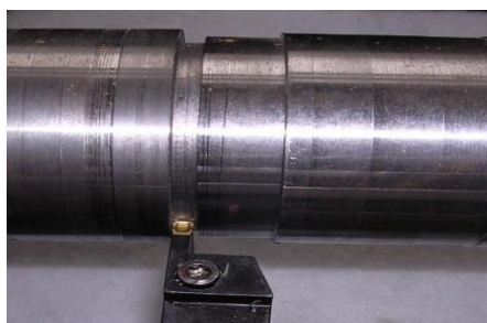
Slika 1.8. Tokarenje profila (utor)
