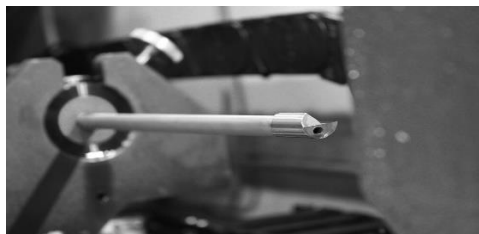
Slika 1.52. Svrdlo za duboko bušenje
