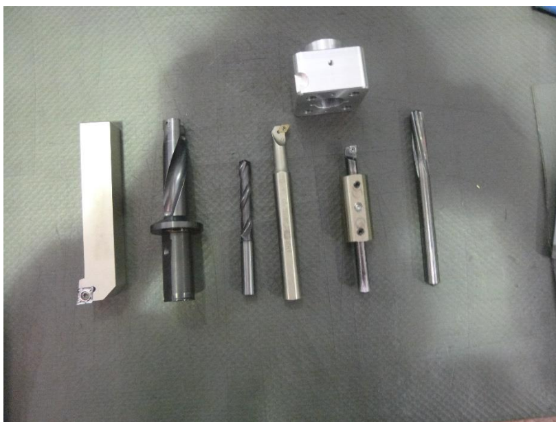
Slika 4.12. Prikaz svih potrebnih alata za izradu trolling kućišta na CNC tokarilici
