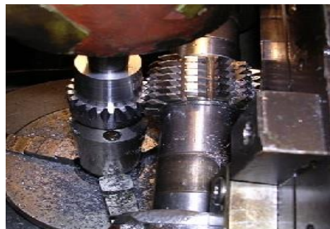
Slika 1.29. Odvalno glodanje zupčanika
