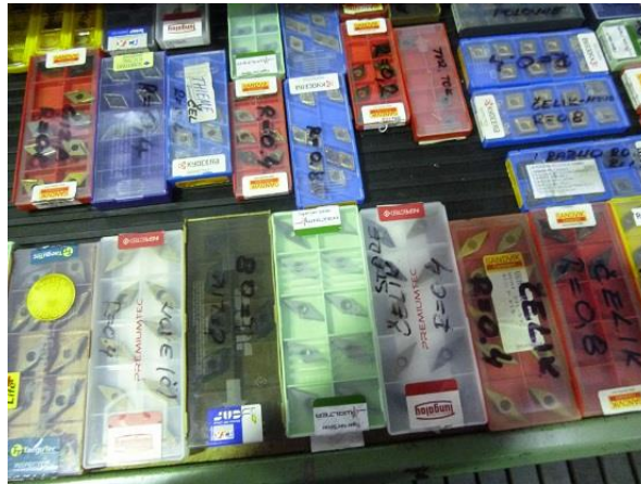
Slika 1.18. Primjer označavanja pločica za tokarenje [8]
