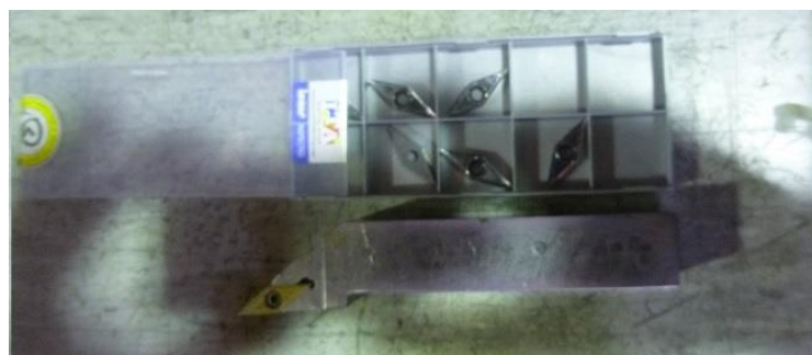
Slika 1.14. Prikaz alata za grubu obradu oznake SCLCR 2525M – 12 uz odgovarajuće rezne pločice u tvrtki „JLM Perković“
