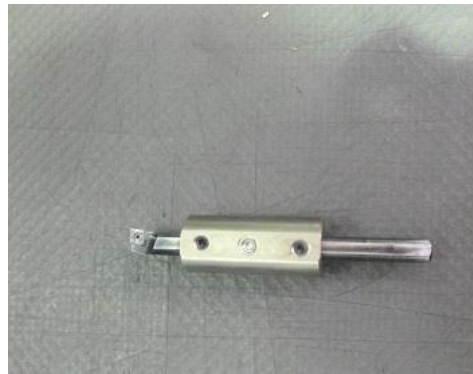
Slika 1.17. Držač za unutarnje tokarenje u tvrtki „JLM Perković“
